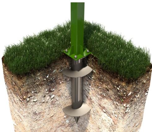
3. Установка стоек с фланцем на винтовую или лопастную сваю (крепление болтами)
