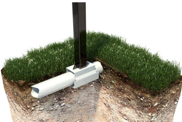
5. Установка стоек на трубу (монтаж при помощи сварки)
