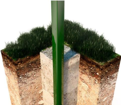
1. Бетонирование стоек
