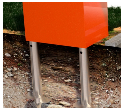
3. Монтаж на винтовые или лопастные сваи.
