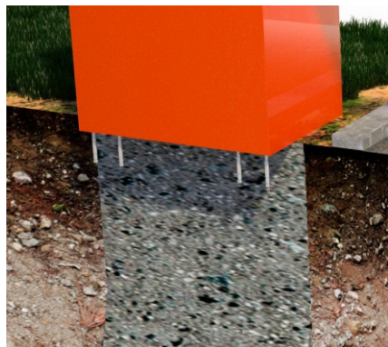
1. Монтаж анкерами на заранее подготовленную бетонную подушку.
